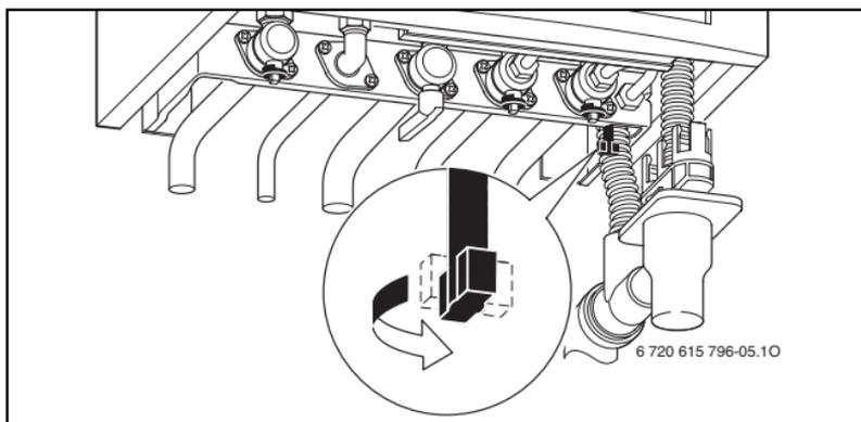
Fig. 6 Robinet de remplissage (appareils GVAC)
