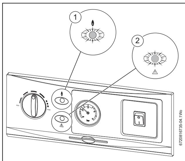
Fig. 4 Les deux lampes de contrôle sont allumées
