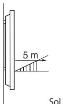
La détection ne se fait pas en dessous du capteur.
