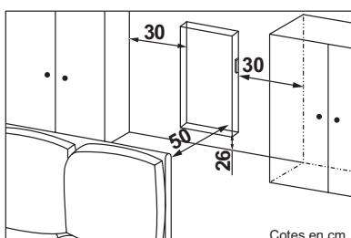
Si vous avez un revêtement mural posé sur mousse il faut mettre une cale sous le support de l'appareil d'épaisseur égale à celle de la mousse afin de conserver un espace libre derrière pour ne pas perturber sa régulation.
