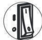
Positionnez l'interrupteur (situé à l'arrière de l'appareil) sur I pour mettre l'appareil sous tension. Lorsque l'appareil est mis hors tension, un nouveau réglage du jour et de l'heure peut être nécessaire.
