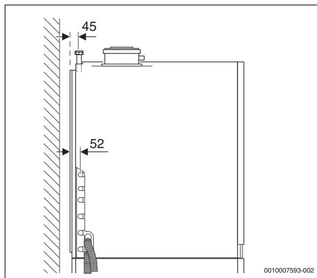
Fig. 8 Dimensions de raccordement de l'accessoire CS 12 - Extension de circuit de chauffage 1 (en mm)
