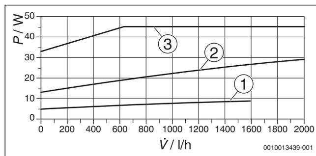
Fig. 122 Puissance absorbée pour les vitesses de pompe I à III
