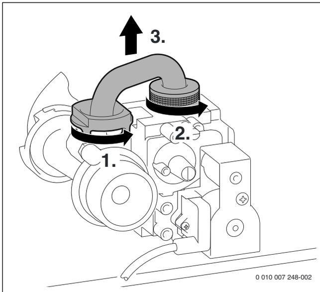
Fig. 107 Retirer le tuyau de gaz
