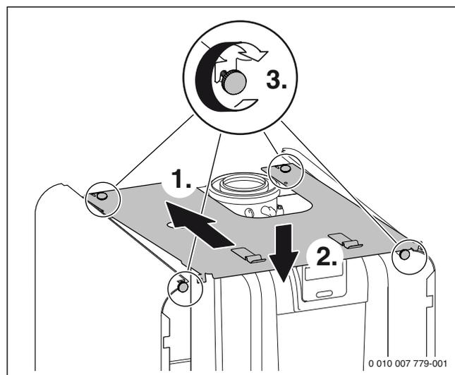
Fig. 80 Glisser le cache supérieur vers l'arrière et fixer à l'avant et l'arrière avec les 4 vis
