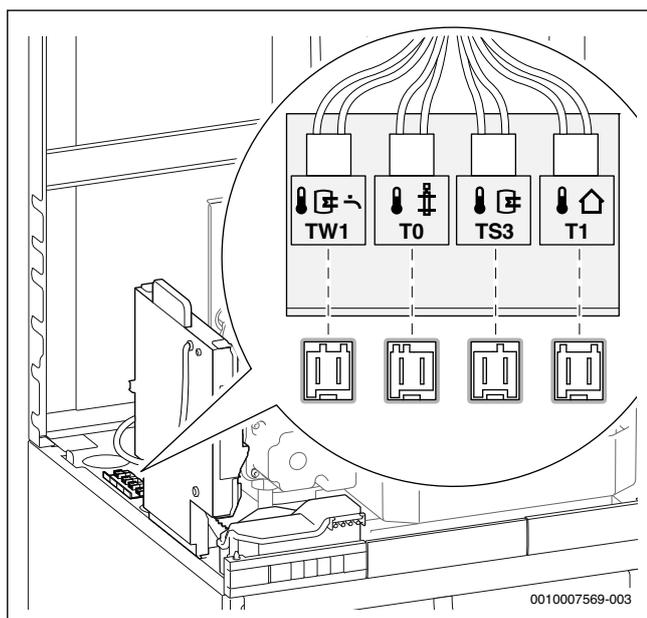
Fig. 70 Connecteur sur l'appareil de commande
