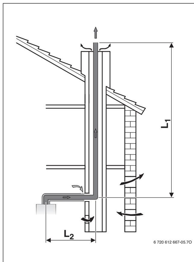
Fig. 17 Evacuation des fumées dans le conduit selon B<sub>33</sub>
