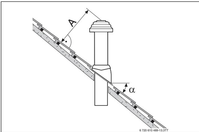
Fig. 15 Distances et pentes pour toits inclinés
