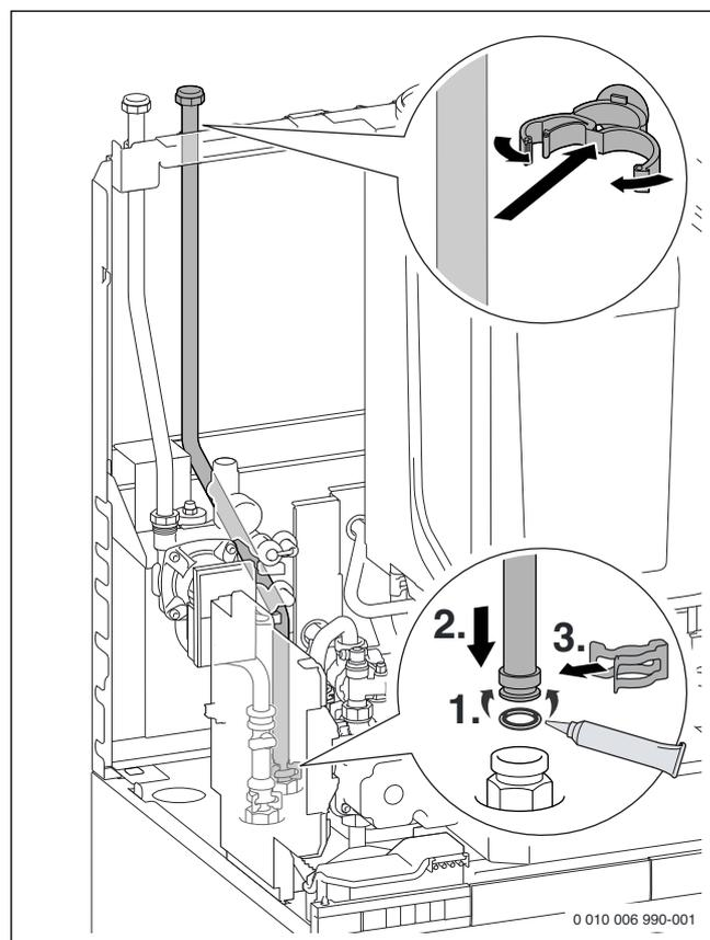
Fig. 60 Monter le tube de départ solaire et fixer le tube en haut
