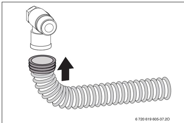
Fig. 33 Monter le flexible sur la soupape de sécurité
