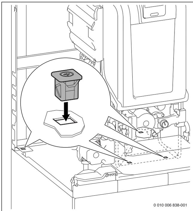
Fig. 40 Fixer l'appareil sur le ballon avec les 4 clips joints
