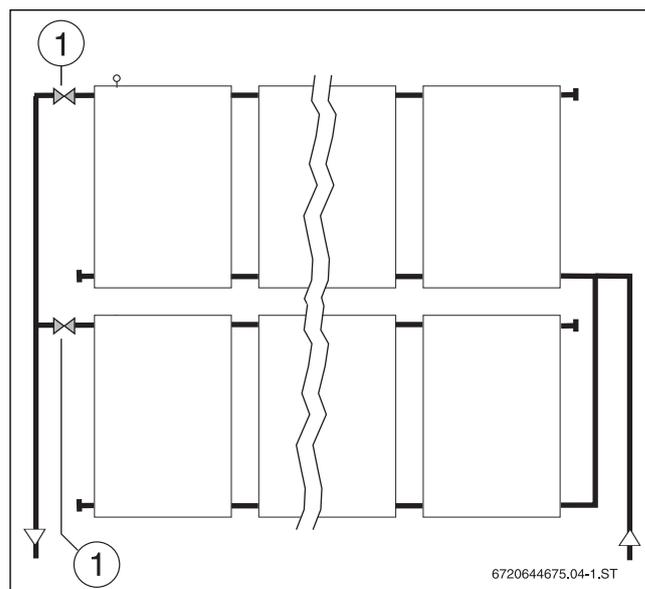
Fig. 75 Rinçage de champs de capteurs parallèles
