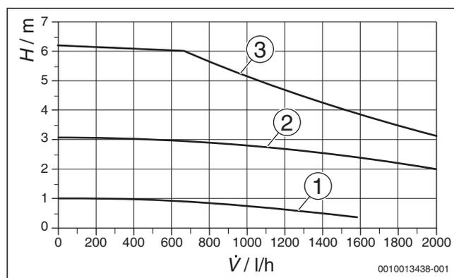
Fig. 120 Courbes caractéristiques de pompe pour les vitesses I à III
