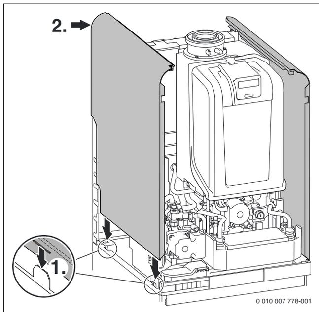
Fig. 79 Monter les panneaux droit et gauche
