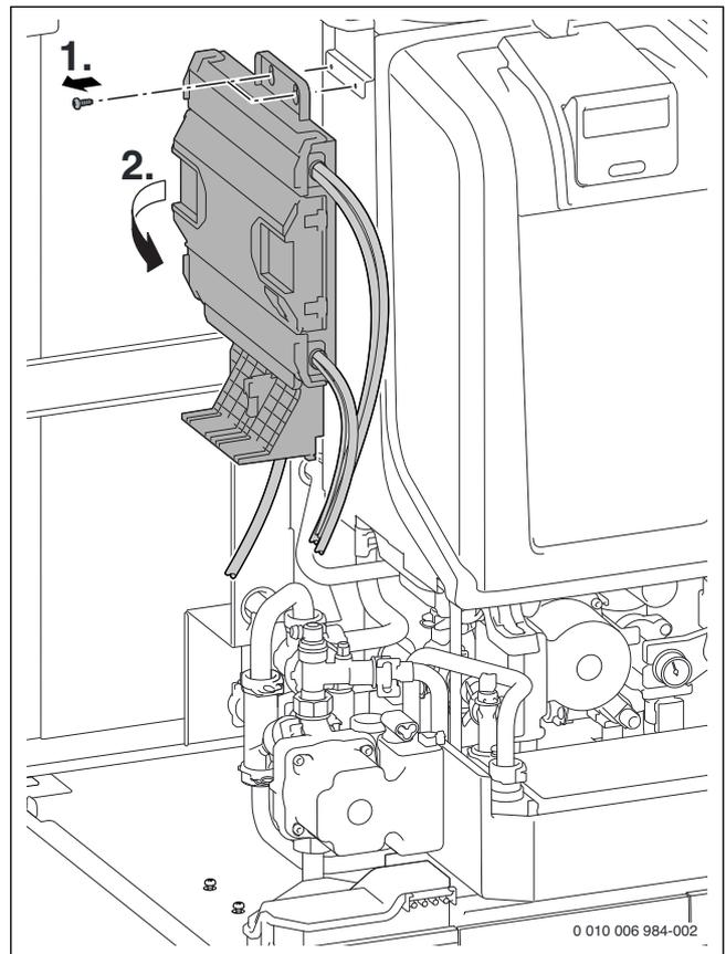
Fig. 47 Retirer l'appareil de commande
