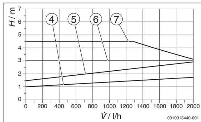
Fig. 121 Courbes caractéristiques de pompe pour pression proportionnelle et constante
