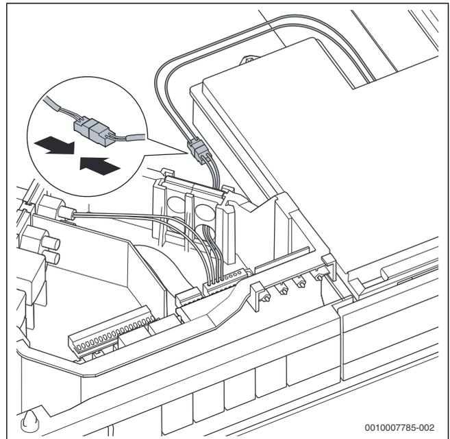
Fig. 55 Raccorder le tiroir du régulateur au boîtier de raccordement
