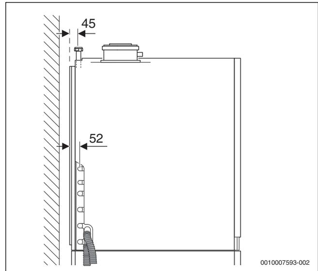
Fig. 10 Dimensions de raccordement de l'accessoire CS 13 - Extension de circuit de chauffage 2 (en mm)
