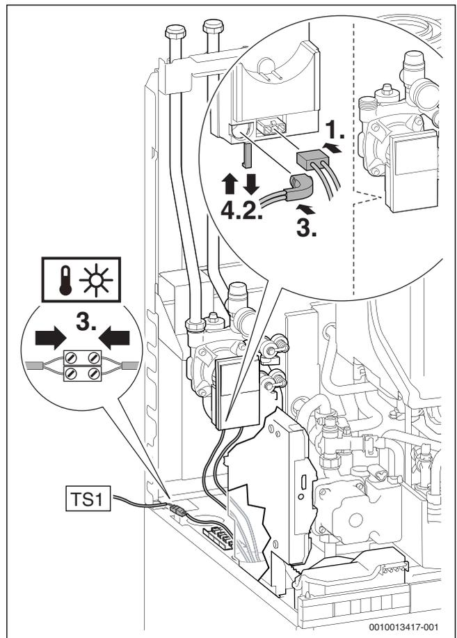
Fig. 64 Raccordement de la pompe solaire et de la sonde de température du capteur TS1
