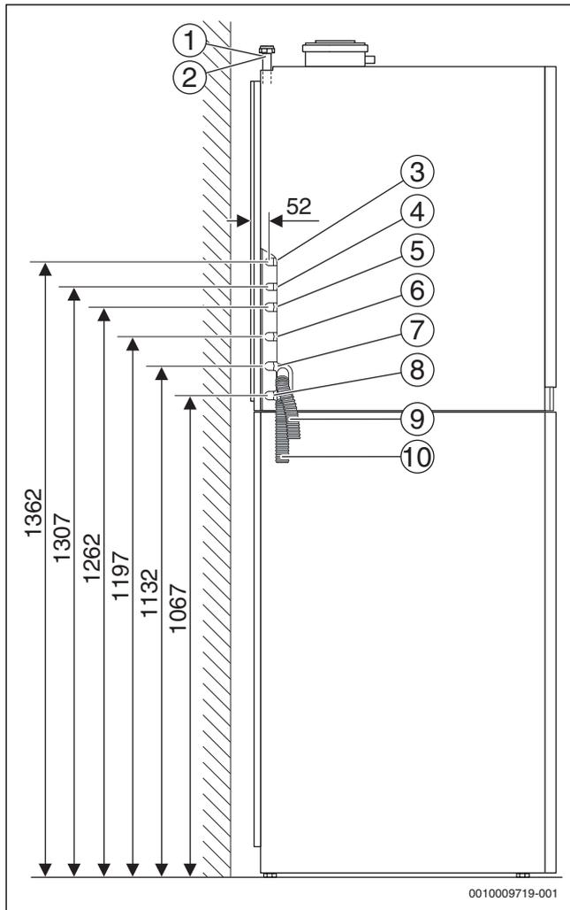
Fig. 4 Dimensions de raccordement de l'accessoire CS 10 - Kit de raccordement horizontal (en mm)
