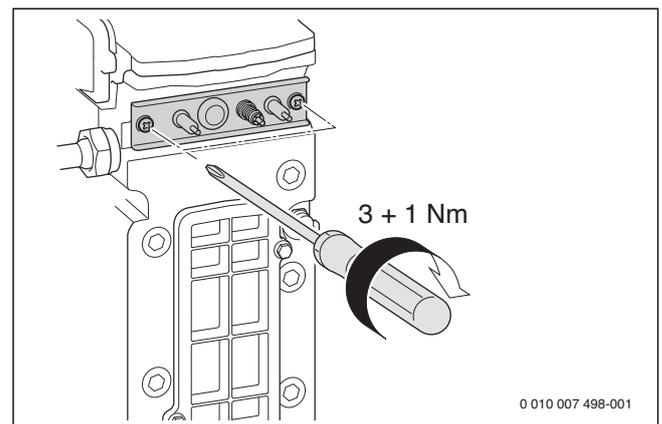
Fig. 91 Remonter le jeu d'électrodes
