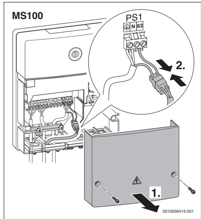
Fig. 72 Raccorder le connecteur du limiteur de température solaire MS1 dans le module MS 100
