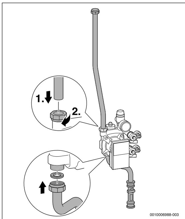
Fig. 58 Monter le tuyau solaire de retour et le limiteur de débit au groupe solaire
