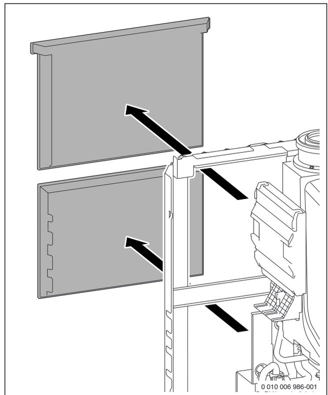
Fig. 56 Retirer les isolations thermique à l'arrière
