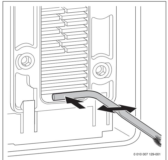
Fig. 100 *Nettoyer le bac des condensats*
