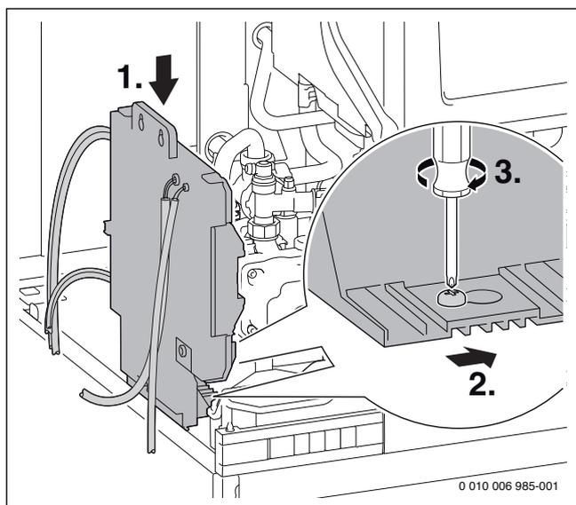
Fig. 48 Fixer l'appareil de commande sur le ballon
