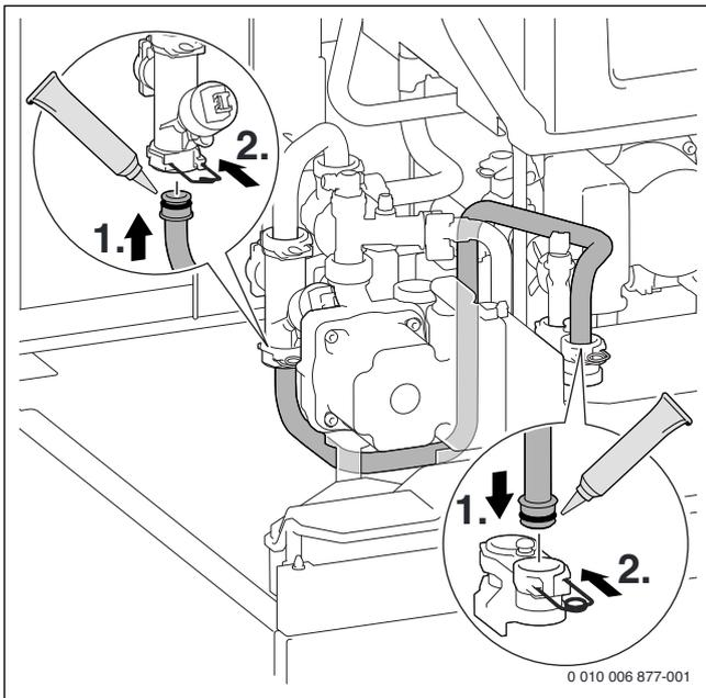
Fig. 45 Raccorder le tuyau entre la vanne à 3 voies et l'échangeur à plaque (départ)
