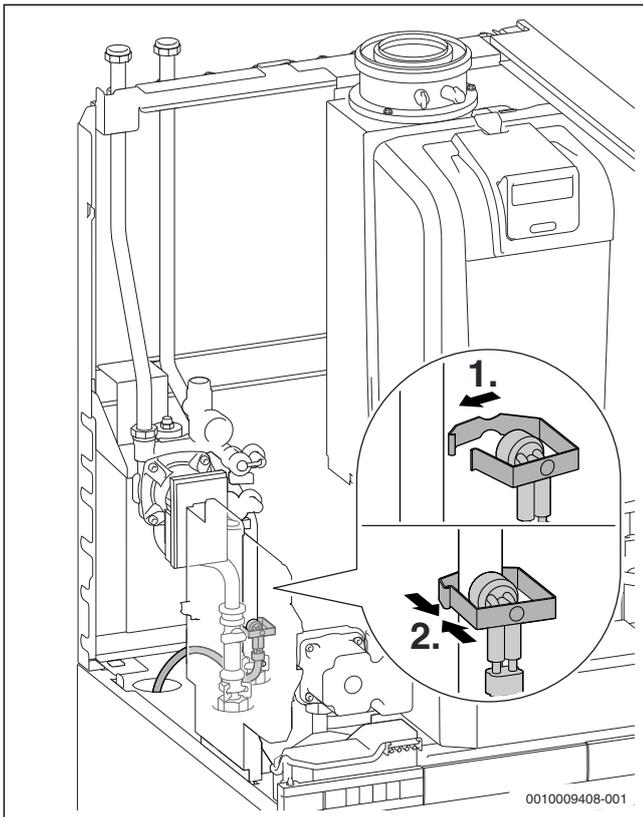
Fig. 61 Monter le limiteur de température solaire MS1 sur le tube de départ solaire
