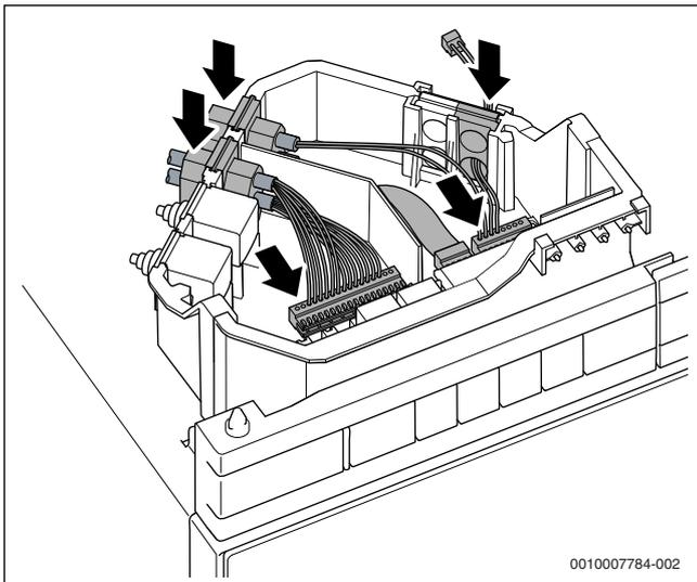
Fig. 53 Raccorder l'appareil de commande au boîtier de raccordement
