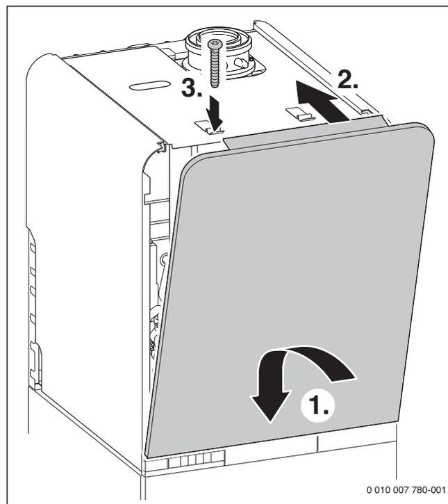
Fig. 81 Fixer la façade avant et fixer à l'aide de la vis fournie
