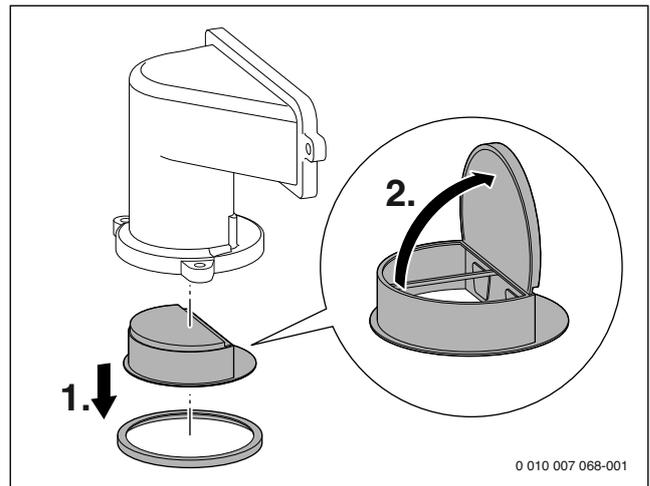
Fig. 95 Clapet anti-retour du dispositif de mélange
