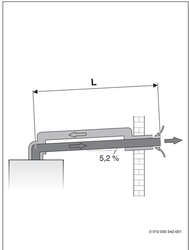
Fig. 21 Evacuation des fumées horizontale selon C<sub>13</sub>
