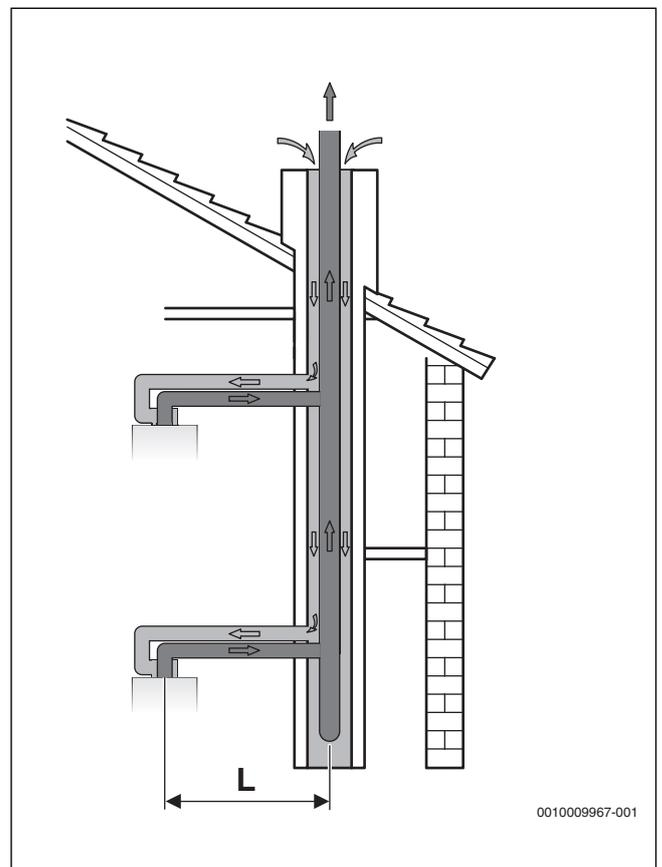
Fig. 28 Affectation multiple avec tube séparé selon C<sub>43</sub>
