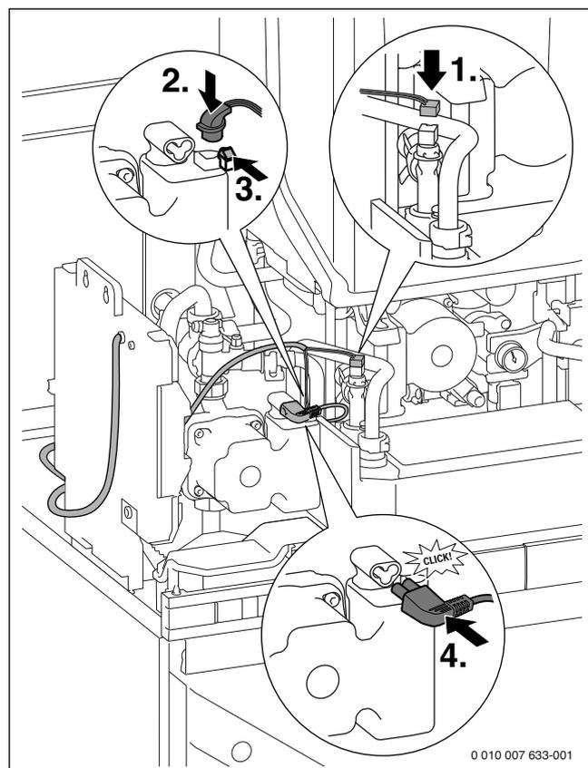
Fig. 50 Raccorder la pompe de charge ECS et la sonde de température ECS
