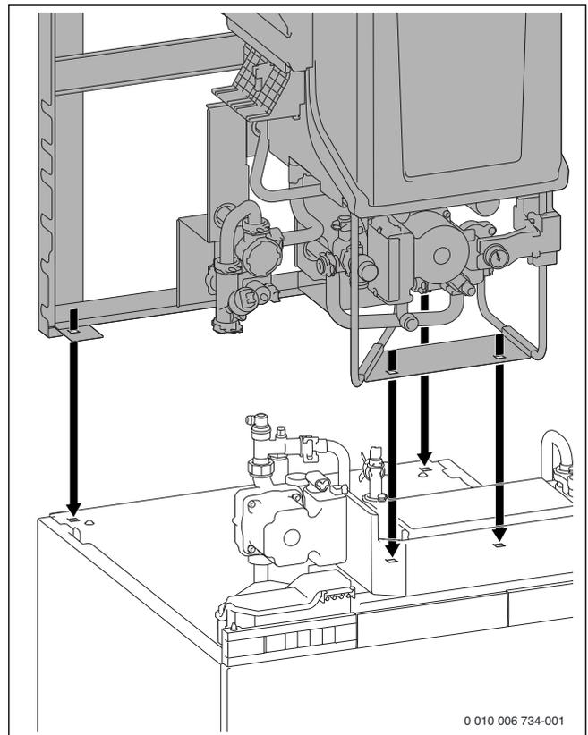
Fig. 39 Placer l'appareil sur le ballon
