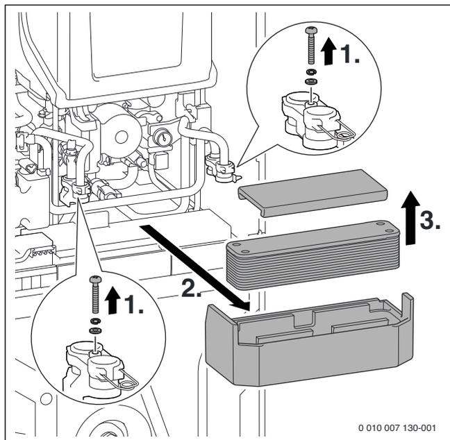
Fig. 105 démonter l'échangeur à plaques
