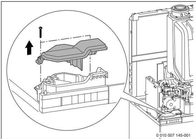
Fig. 52 Retirer le couvercle du boîtier de raccordement
