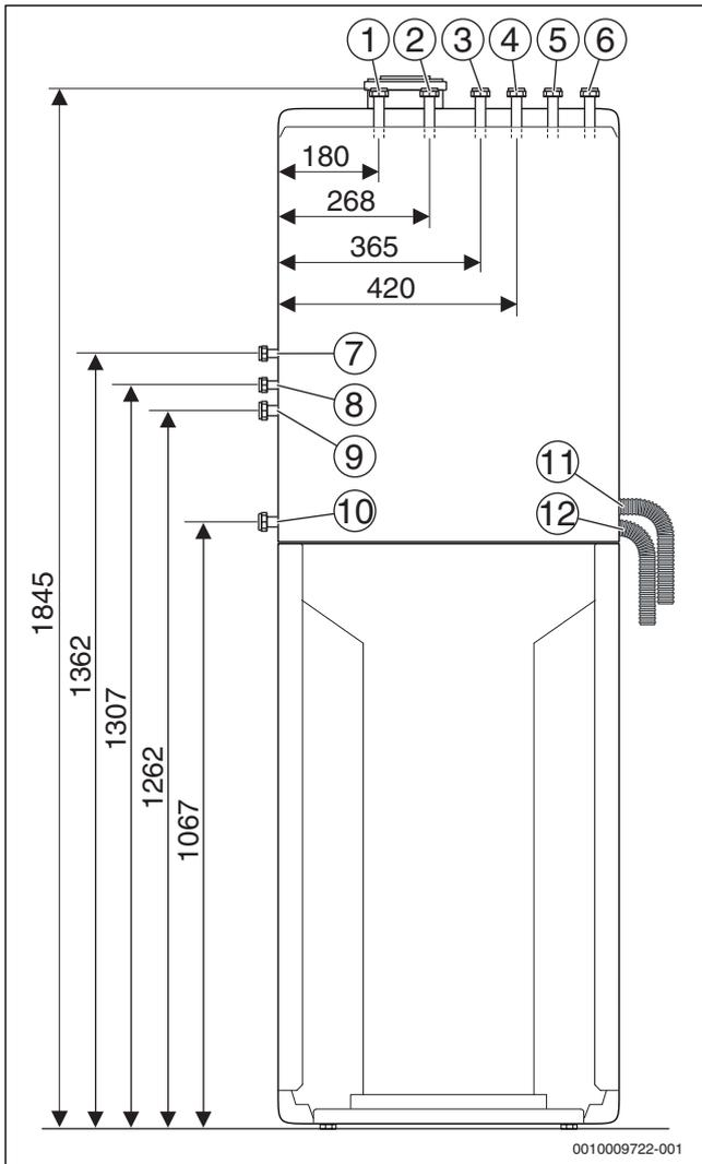
Fig. 9 Dimensions de raccordement de l'accessoire CS 13 - Extension de circuit de chauffage 2 (en mm)
