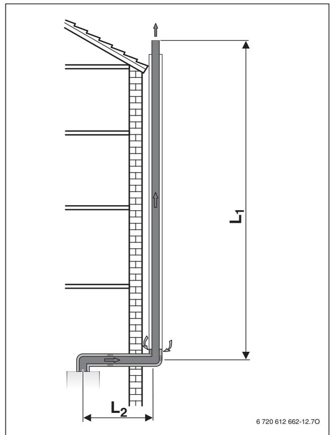
Fig. 25 Evacuation des fumées sur la façade selon C<sub>53</sub>
