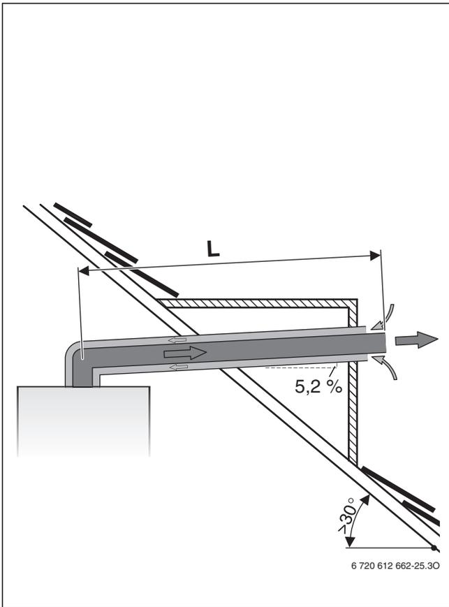
Fig. 22 Evacuation des fumées horizontale selon C<sub>13</sub>
