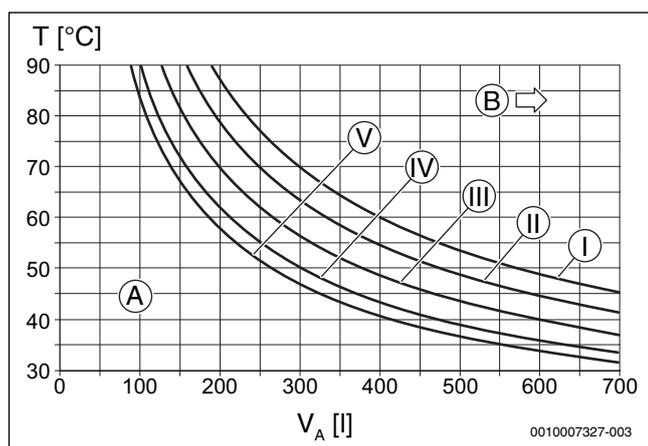
Fig. 32 Courbes caractéristiques du vase d'expansion 17 l
