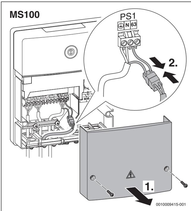
Fig. 62 Raccorder le connecteur du limiteur de température solaire MS1 dans le module MS 100
