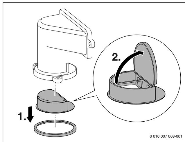
Fig. 104 Clapet anti-retour du dispositif de mélange
