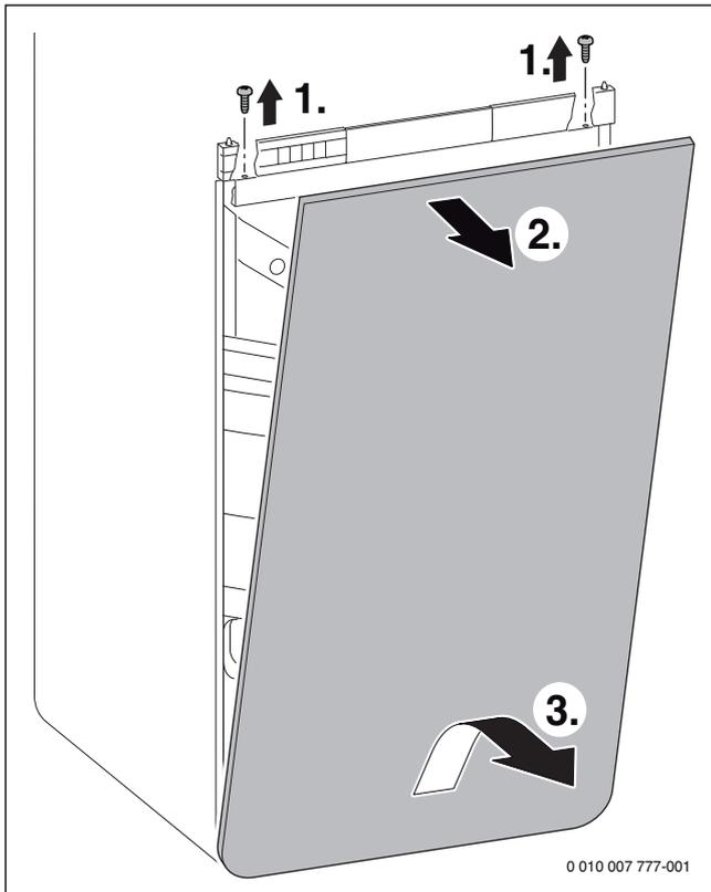
Fig. 37 Retirer la façade avant du ballon
