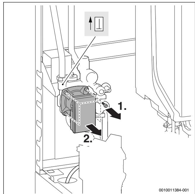
Fig. 110 Démontez la pompe solaire
