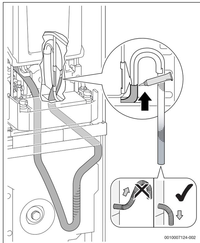
Fig. 43 Insérer le tube siphon sur son support
