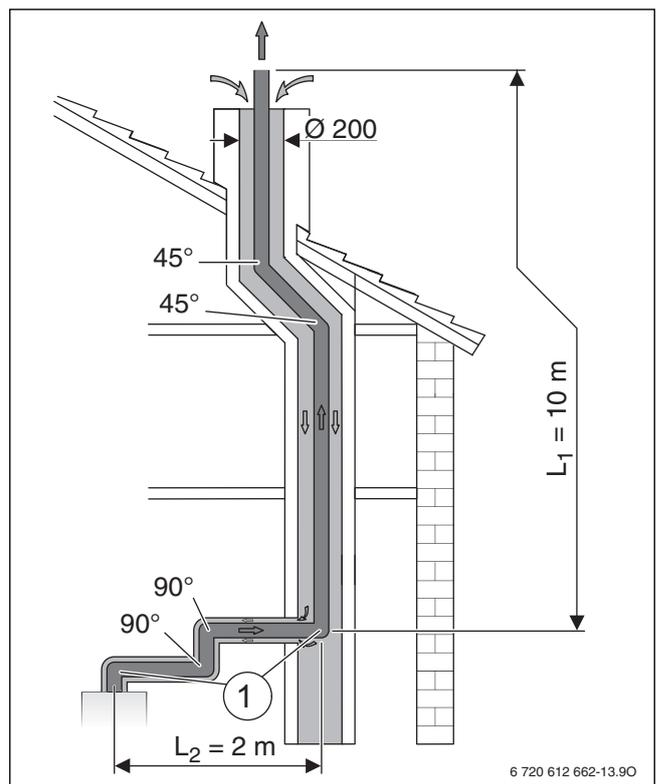
Fig. 26 Situation de montage d'un système d'évacuation des fumées dans le conduit selon C<sub>93</sub>
