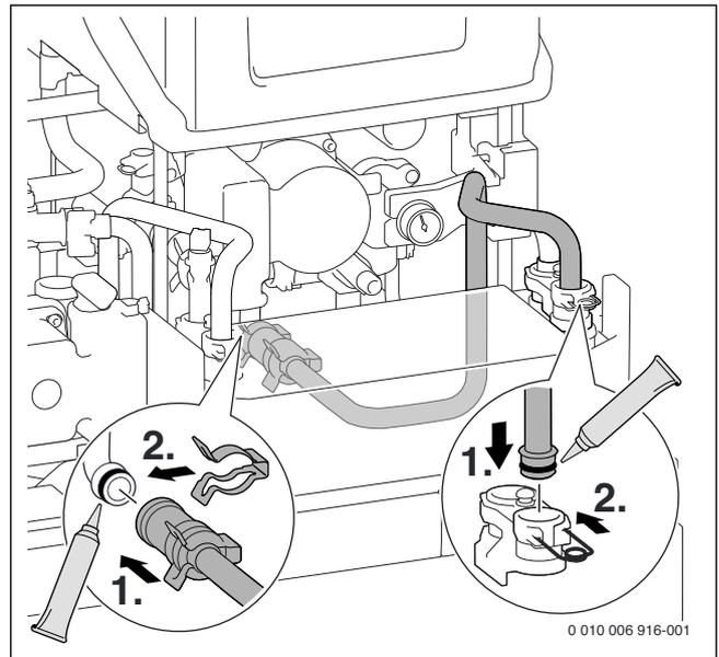
Fig. 46 Raccorder le tuyau entre l'échangeur à plaque et le corps de chauffe (retour)
