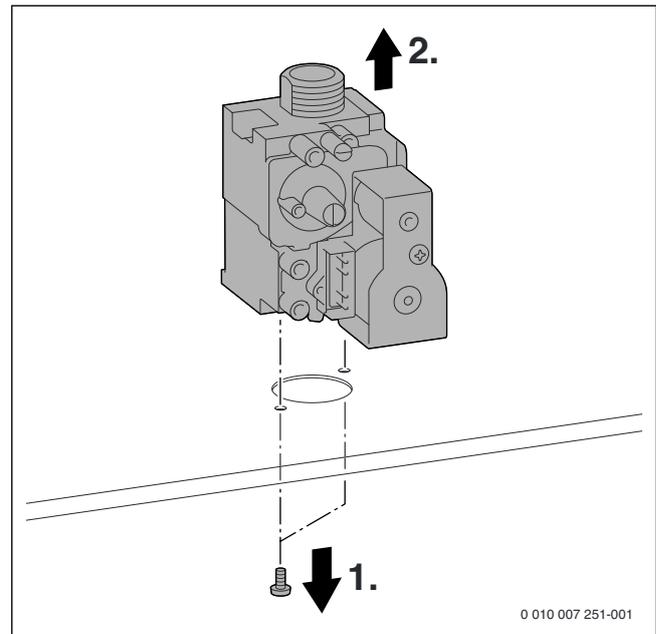
Fig. 109 Démontez le bloc gaz
