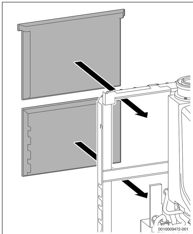
Fig. 78 Montage des isolations thermiques à l'arrière
