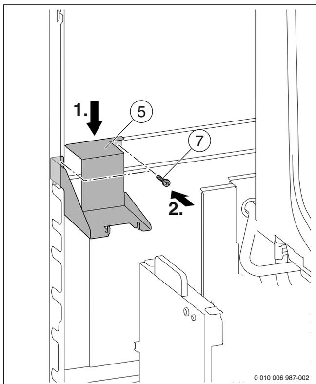
Fig. 57 Fixer le support du groupe solaire à l'aide de la vis
