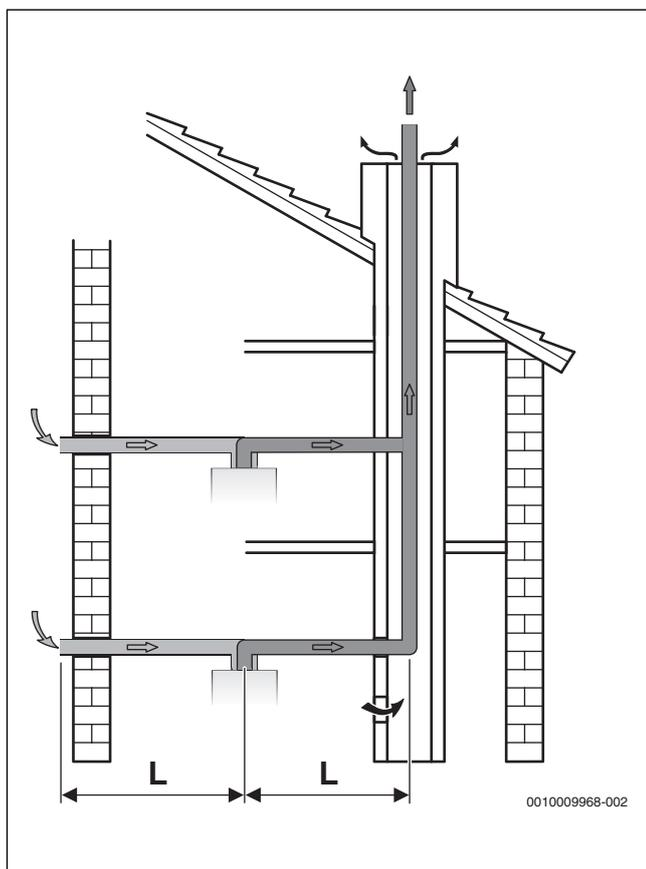
Fig. 29 Affectation multiple avec tube séparé selon C<sub>83</sub>
