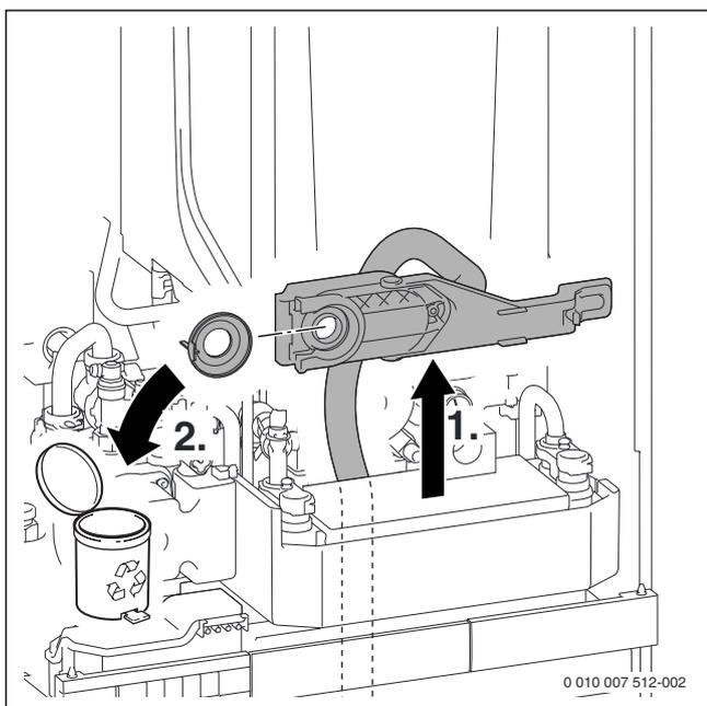
Fig. 41 Retirer le filtre de la position d'entretien et retirer le couvercle de protection
