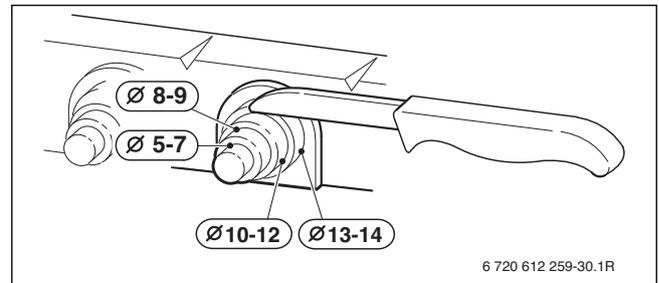
Fig. 67 Adapter le serre-câble au diamètre du câble
