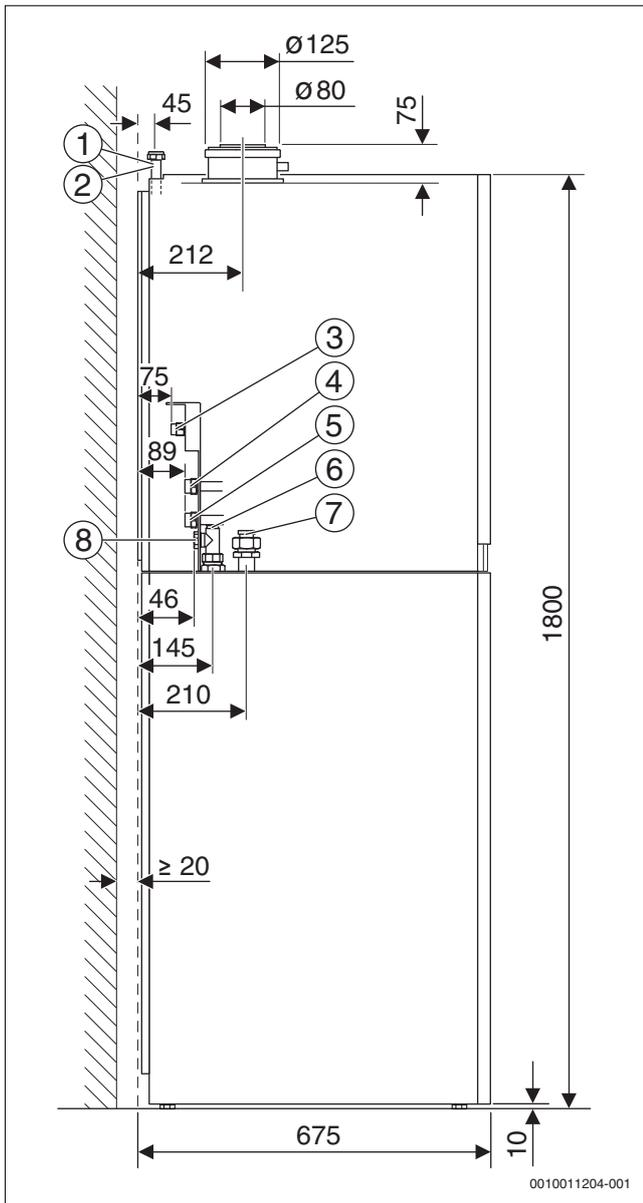
Fig. 2 Dimensions et raccords sans accessoires (en mm)
