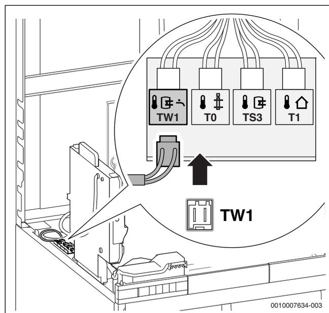
Fig. 51 Raccorder la sonde de température ballon
