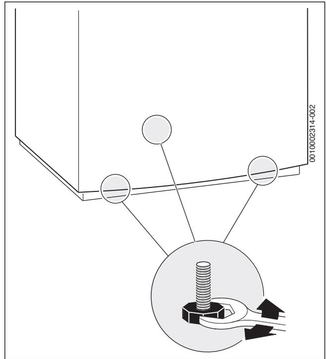
Fig. 38 Positionner le ballon
