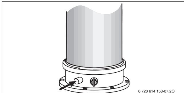
Fig. 88 Buse de mesure des fumées
