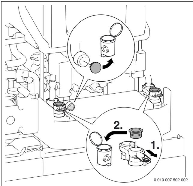
Fig. 44 Retirer le bouchon sur le corps de chauffe et l'échangeur à plaques
