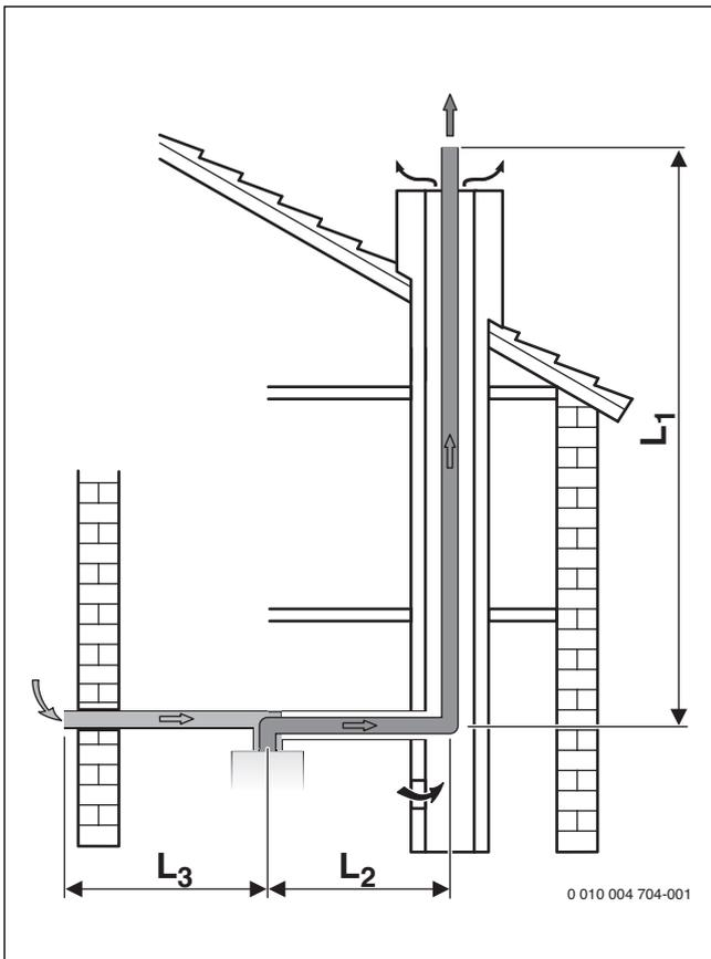
Fig. 19 Evacuation des fumées dans le conduit selon C<sub>53</sub>
