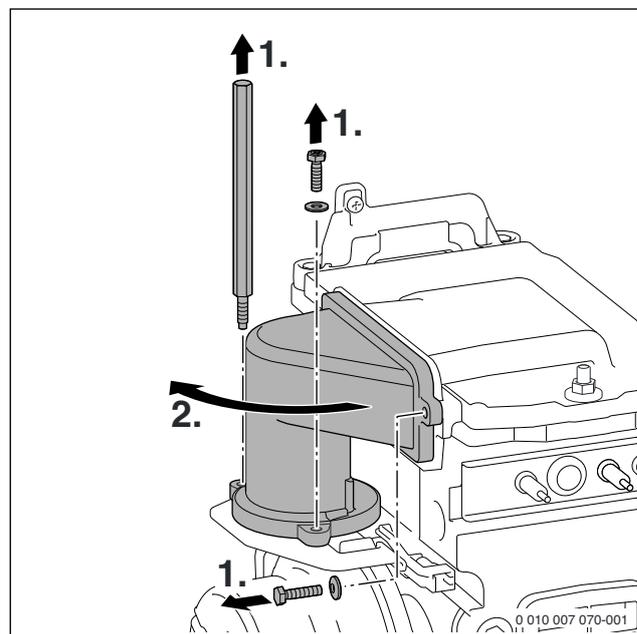
Fig. 103 Démontez le dispositif de mélange
