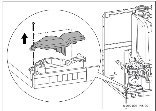
Fig. 66 Retirer le couvercle du boîtier de raccordement
