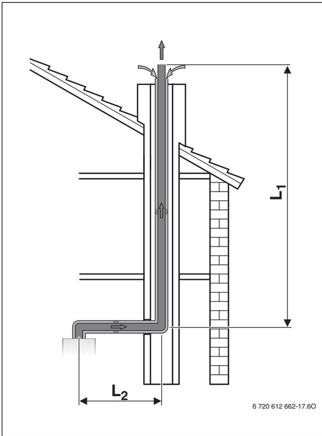
Fig. 18 Evacuation des fumées avec le tube concentrique dans le conduit selon C<sub>33</sub>
