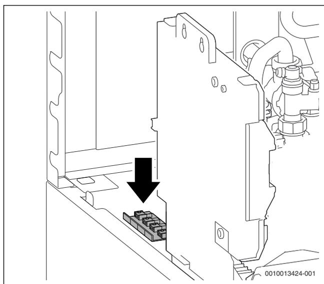
Fig. 49 Fixer la barrette de raccordement sur le ballon
