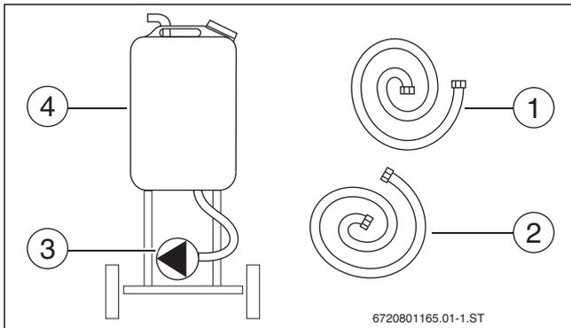
Fig. 76 Composants d'un dispositif de remplissage
