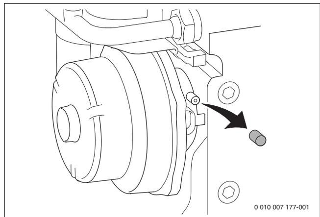
Fig. 96 Buse de mesure sur la chambre de mélange
