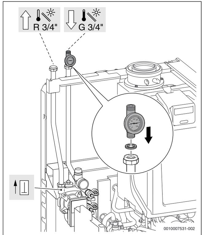
Fig. 63 Monter la vanne d'isolement avec thermomètre sur le tuyau de départ solaire
