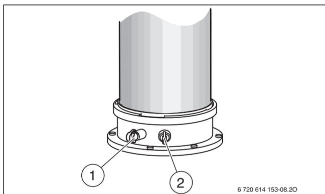
Fig. 90 Buse de mesure des fumées et de l'air de combustion
