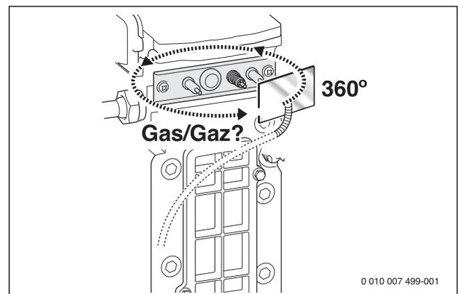
Fig. 92 Contrôle d'étanchéité
