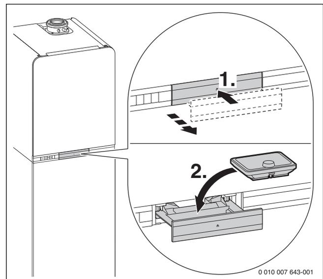
Fig. 73 Insérer le régulateur de chauffage
