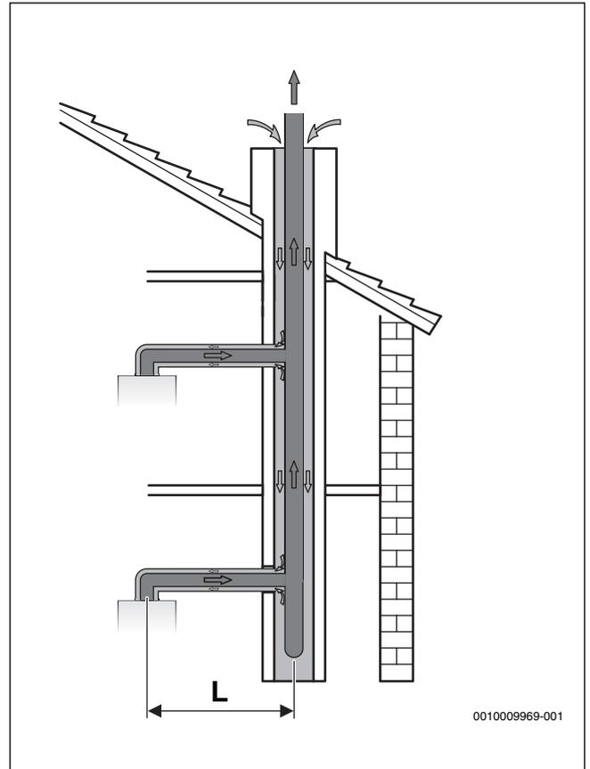
Fig. 27 Affectation multiple avec tube concentrique selon C<sub>43</sub>
