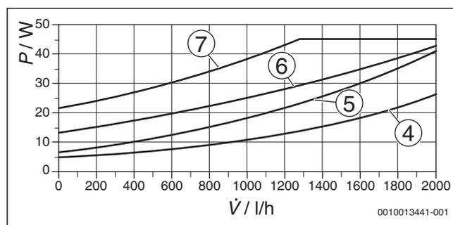
Fig. 123 Puissance absorbée pour pression proportionnelle et constante
