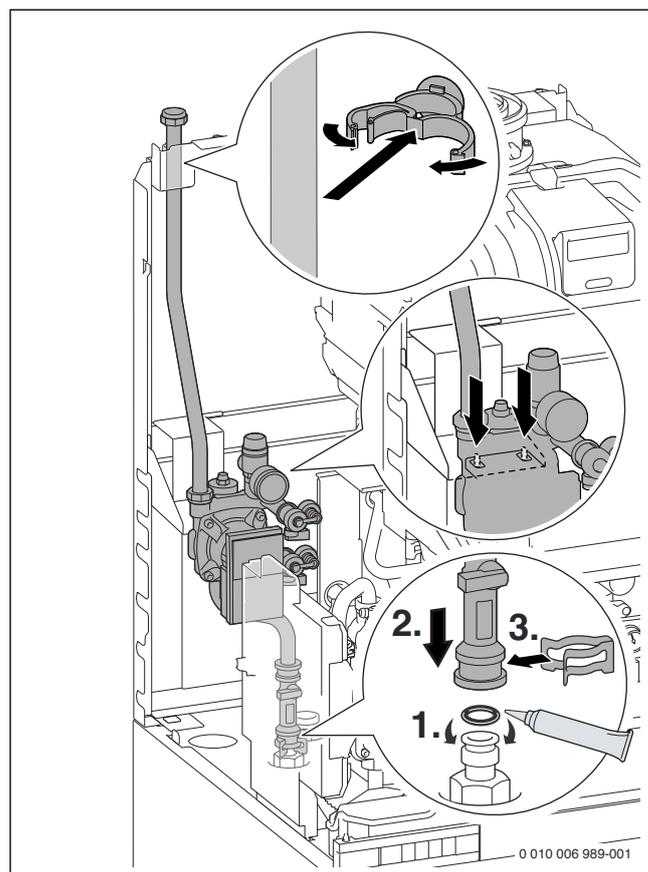
Fig. 59 Accrocher le groupe solaire dans le support et raccorder le débitmètre au ballon
