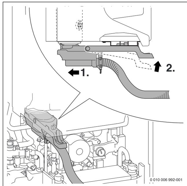
Fig. 42 Monter le filtre
