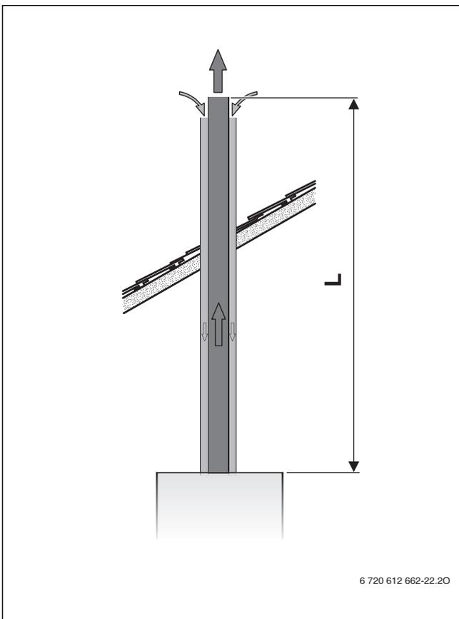
Fig. 23 Evacuation verticale des fumées selon C<sub>33</sub>
