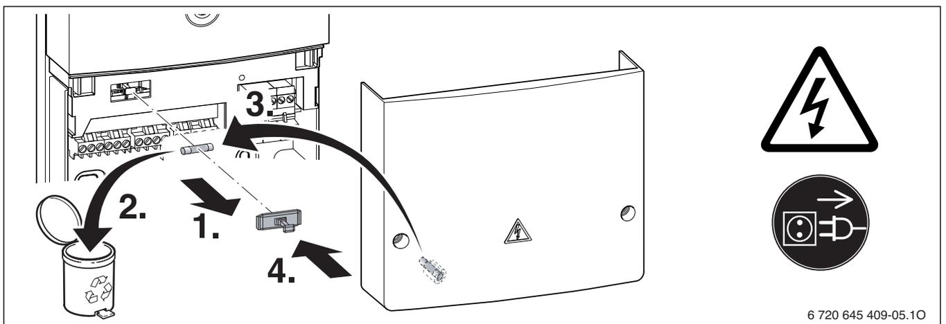
Fig. 113 Remplacer le fusible du module
