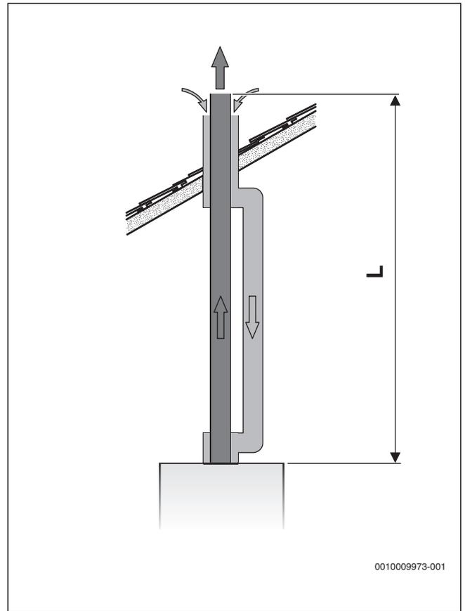
Fig. 24 Evacuation verticale des fumées selon C<sub>33</sub>
