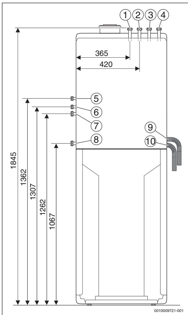
Fig. 7 Dimensions de raccordement de l'accessoire CS 12 - Extension de circuit de chauffage 1 (en mm)
