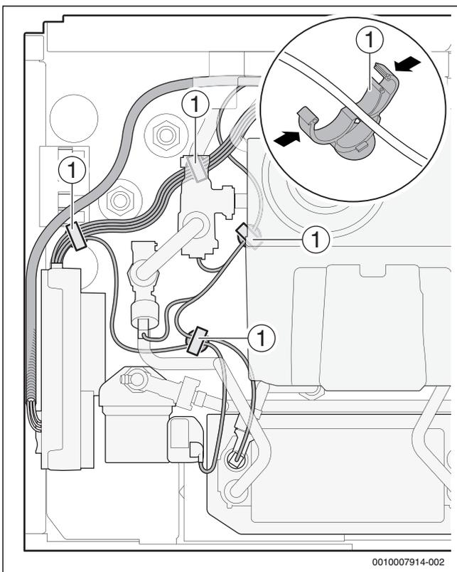
Fig. 54 Fixer le câble avec 4 clips
