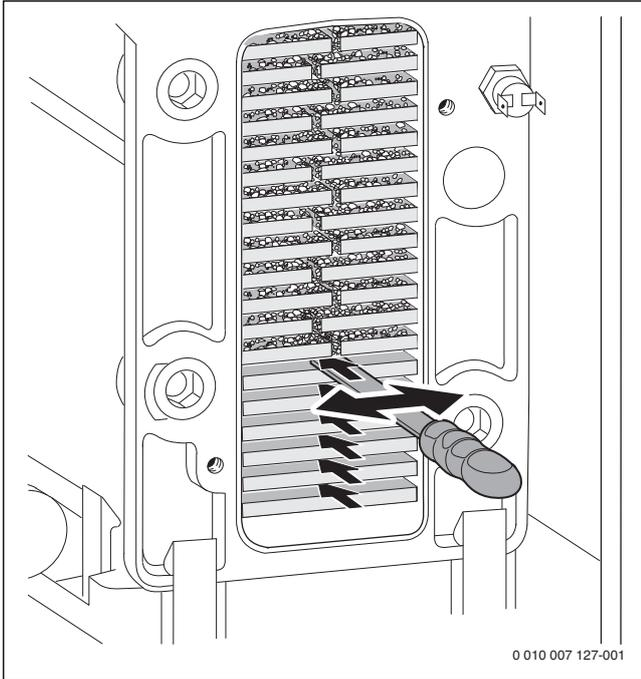
Fig. 97 *Lame de nettoyage*
