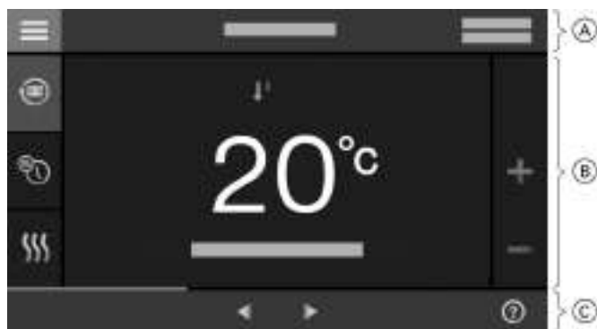
Fig. 5 Exemple : Marche en fonction de la température extérieure
