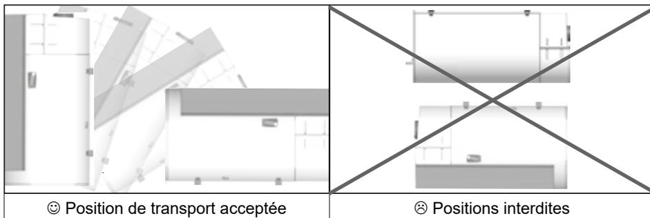
Respecter les recommandations de transport et de manutention figurant sur l'emballage du chauffe-eau.
