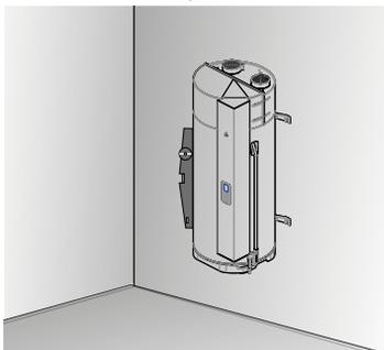
Découper le gabarit imprimé sur le carton et l'utiliser pour faire les marquages. Procéder au scellement de boulons  $\varnothing$  10 mm, ou au percement pour recevoir des chevilles de type MOLLY  $\varnothing$  10 mm. Le mur doit tenir une charge de 300 kg minimum.
