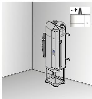
Il est obligatoire de poser le chauffe-eau sur un support (quadripode en option). Poser le chauffe-eau sur le support pour marquer les points de fixation. Réaliser les perçages puis réinstaller le chauffe-eau à sa place. La fixation anti-basculement par l'étrier supérieur est obligatoire (fixation  $\varnothing$  10 mm minimum adaptée au mur ou avec la sangle de portage).
