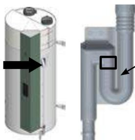
Produit à l'arrêt, remplir en eau le siphon jusqu'à la flèche, par le tube d'évacuation des condensats.
