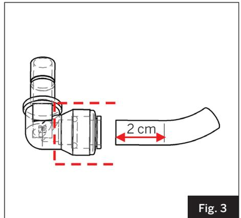
3. Fixez le tuyau sur le coude de vidange, comme stipulé dans la figure 2. Assurez-vous que tube est inséré de 2 cm dans le raccord comme illustré dans la figure 3.
