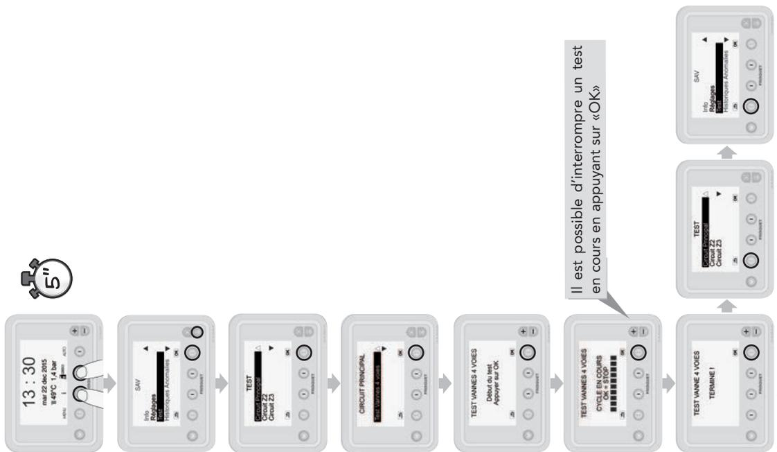
**A l'issue d'un test :** il est impératif de débrancher puis rebrancher la prise 230V de la **chaudière** (même après le test d'une V4V module).
