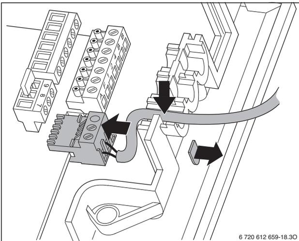
Fig. 44 Raccord sonde de température du ballon (CTN)
