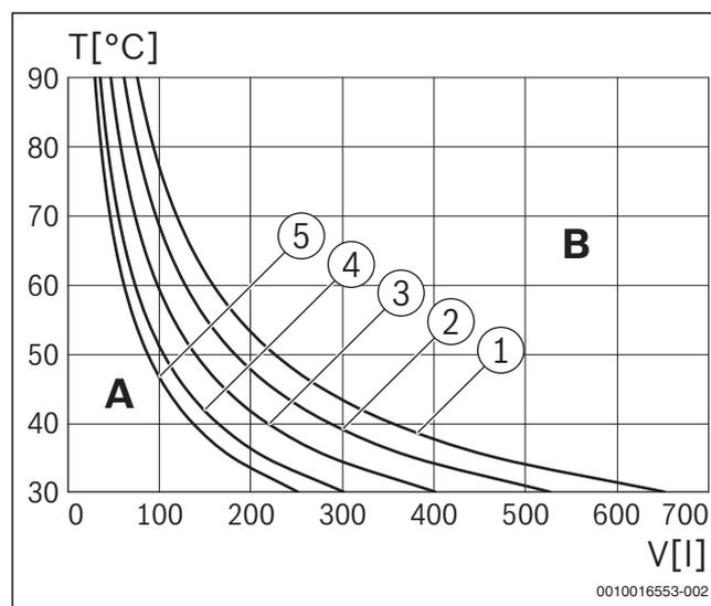
Fig. 24 Courbes caractéristiques du vase d'expansion
