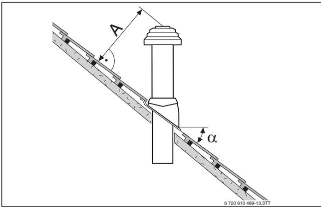
Fig. 10 Distances et pentes pour toits inclinés
