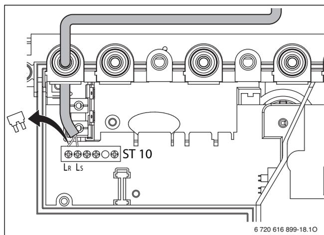
Fig. 41 Raccordement du TRL .. (230 V CA, retirer le cavalier entre L<sub>S</sub> et L<sub>R</sub>)
