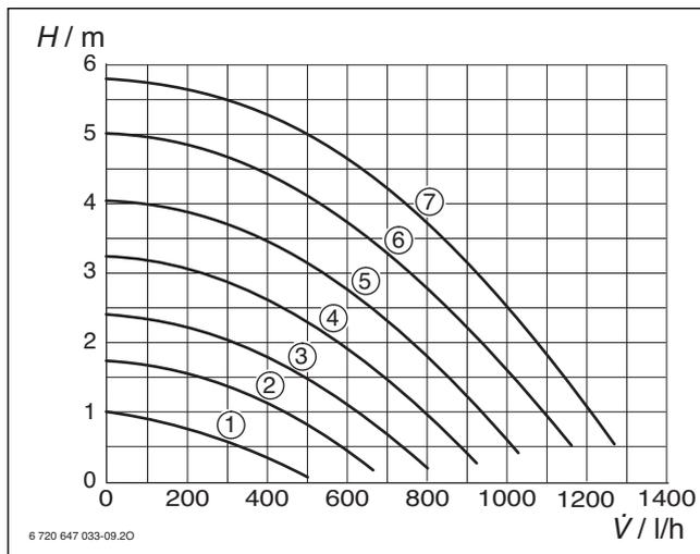
Fig. 59 Courbes caractéristiques du circulateur
