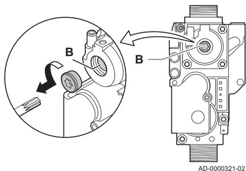
4. À l'aide de la vis de réglage **B**, régler le pourcentage de O<sub>2</sub> à la valeur nominale, en fonction du type de gaz utilisé. Cette valeur doit toujours être comprise entre les limites de paramétrage inférieure et supérieure.
