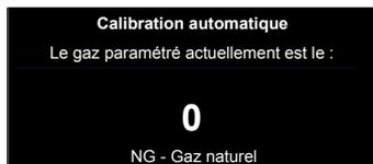
**“Calibrage automatique de la chaudière. L'opération peut prendre quelques minutes. Si vous voulez lancer le calibrage automatique, appuyez sur OK”**
