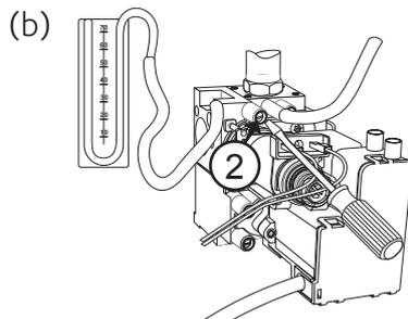
2. Déconnecter le tuyau de compensation de la chambre à air.
