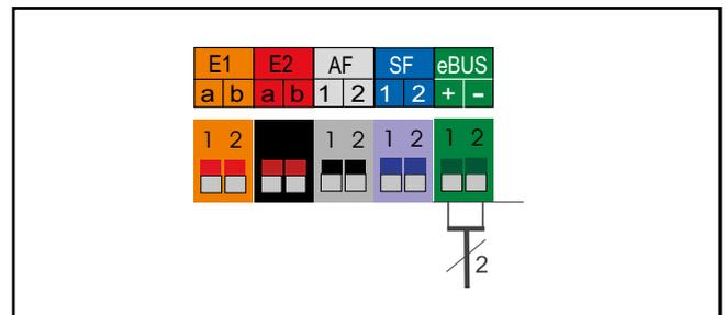
Illustration : raccordement d'accessoires numériques de régulation Wolf (interface eBus)
