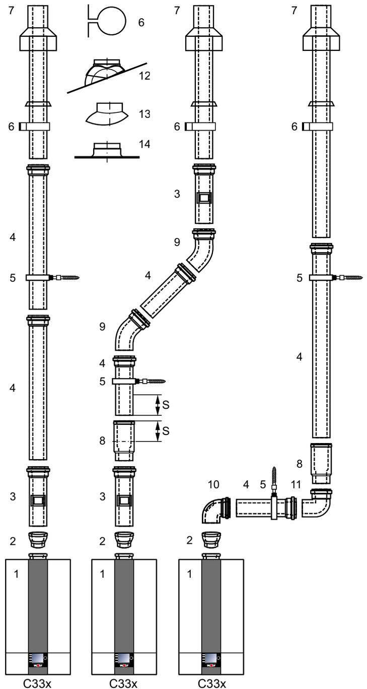
**Type C33x :** chaudière gaz murale à condensation avec conduite d'alimentation verticale d'air de combustion et de fumées à travers le toit.
