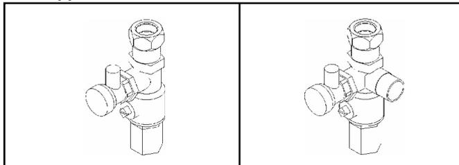
Illustration : robinet d'entretien en ligne, avec robinet de remplissage et vidange (accessoire)
