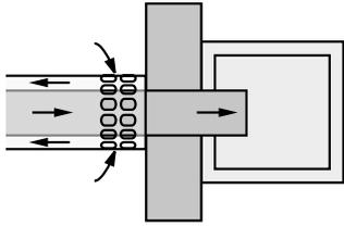
Le raccord pour cheminée des fumées avec orifices d'aération doit être directement monté sur celle-ci, conformément au schéma de sorte que toutes les parties du trajet des fumées soient parcourues par l'air de combustion.
