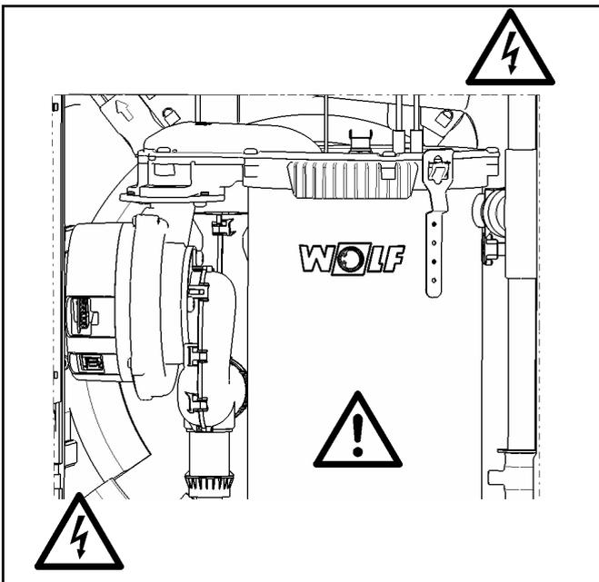
Illustration : transfo d'allumage, électrode d'allumage haute tension, chambre de combustion
