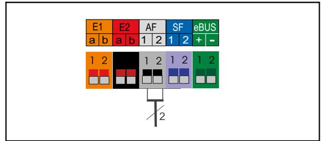
Illustration : raccordement de sonde extérieure
