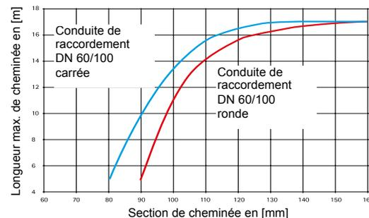
**Raccordement à une cheminée d'air / des fumées (LAS) insensible à l'humidité, cheminée des fumées ou installation d'évacuation des fumées de type C 43x.**
