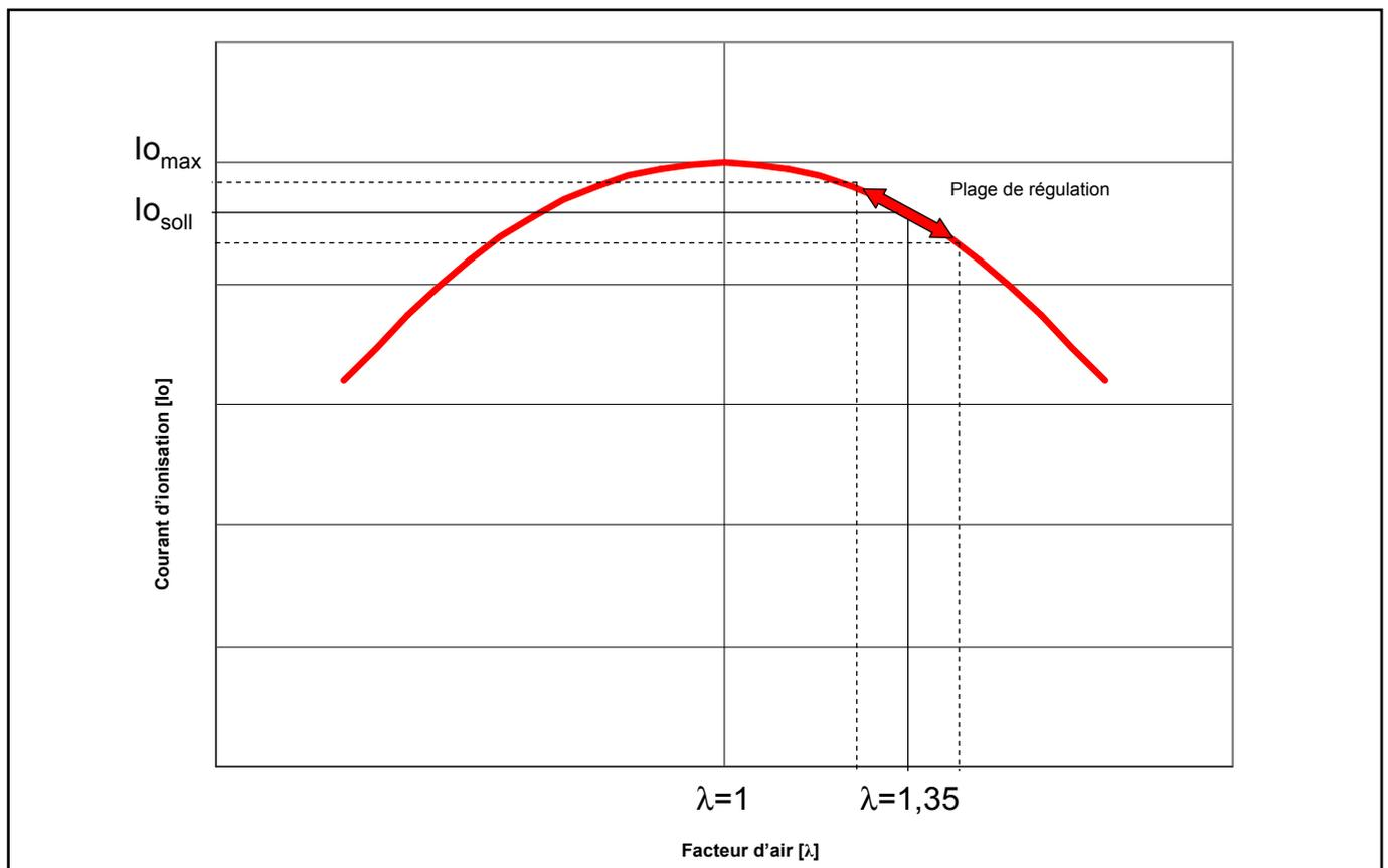
Illustration : diagramme de régulation du courant d'ionisation
