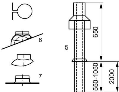
Si un orifice de visite est souhaité dans la conduite d'air / des fumées, il faut alors utiliser un conduit ventouse avec visite (2) (prévoir une longueur de 200 mm).
