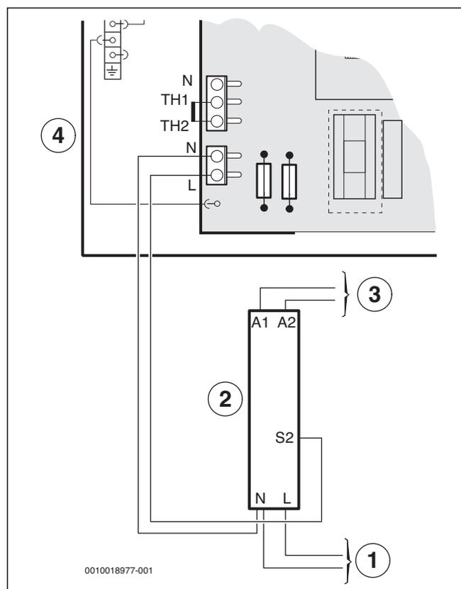
Fig. 20 Schéma de câblage et de principe
