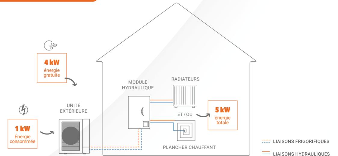
Dans le cas d'une pompe à chaleur air / eau cette énergie permet de chauffer l'eau contenue dans le réseau hydraulique afin d'alimenter radiateurs ou planchers chauffants.
