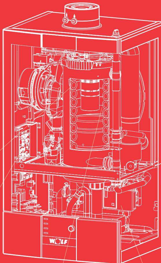
Le corps de chauffe recouvert de silicium limite les résidus de combustion et renforce l'efficacité et la longévité.
